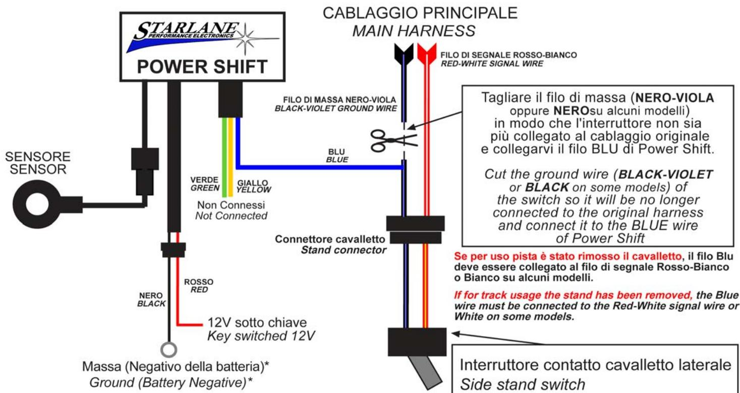
\*Nota: il sistema può funzionare solo se il negativo dell'alimentazione viene messo in comune con l'impianto o il telaio del veicolo
