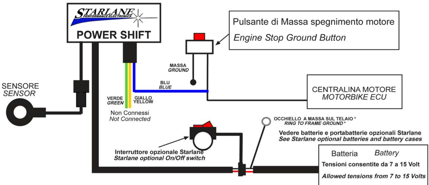
\*Nota: il sistema può funzionare solo se il negativo dell'alimentazione viene messo in comune con l'impianto o il telaio del veicolo
